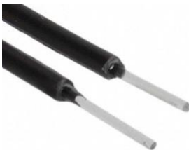
Рисунок 5.2 - Жилы кабеля со снятой изоляцией
