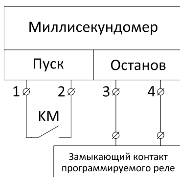
Рисунок 3.8 – Схема запуска и останова миллисекундомера
