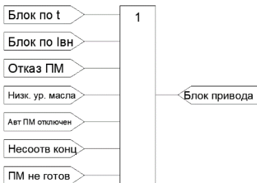
Рисунок 3.5.5 – Функциональная схема формирования сигнала блокировки привода РПН
